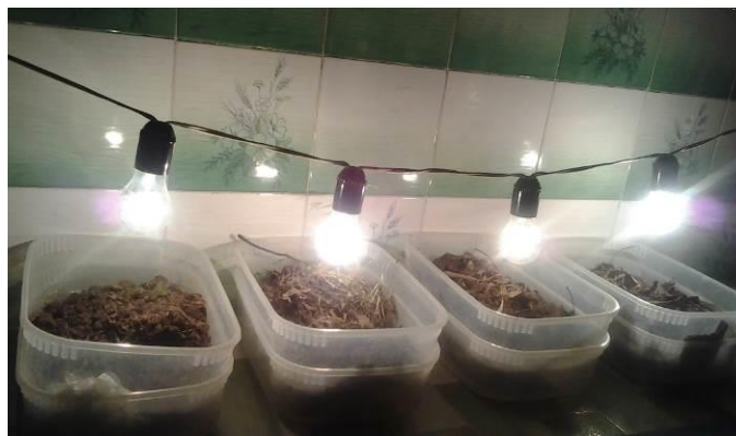
شکل ۲- دستگاه تغییر شکل یافته قیف برلیز برای جداسازی پادمان از خاک و خاک برگ (اصلی)
